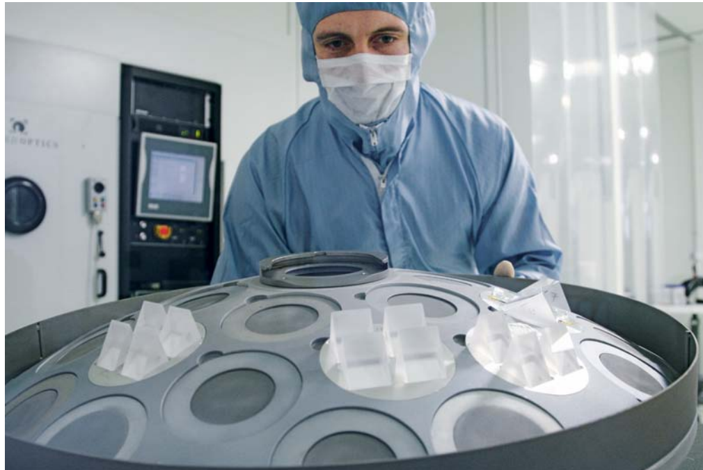
Marko Richter, Meister in der Endfertigung, bereitet Prismen für die Beschichtung vor. Mit modernster Beschichtungstechnik werden sowohl Standardbeschichtungen angeboten, als auch speziell für Spezialoptiken entwickelte Schichten hergestellt.
